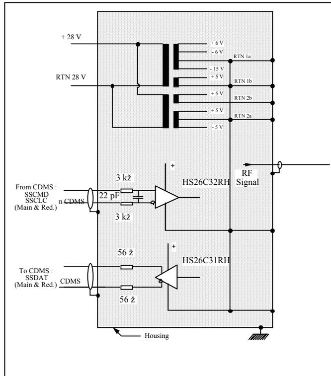
Figure 5.4.1a : Interface circuits
