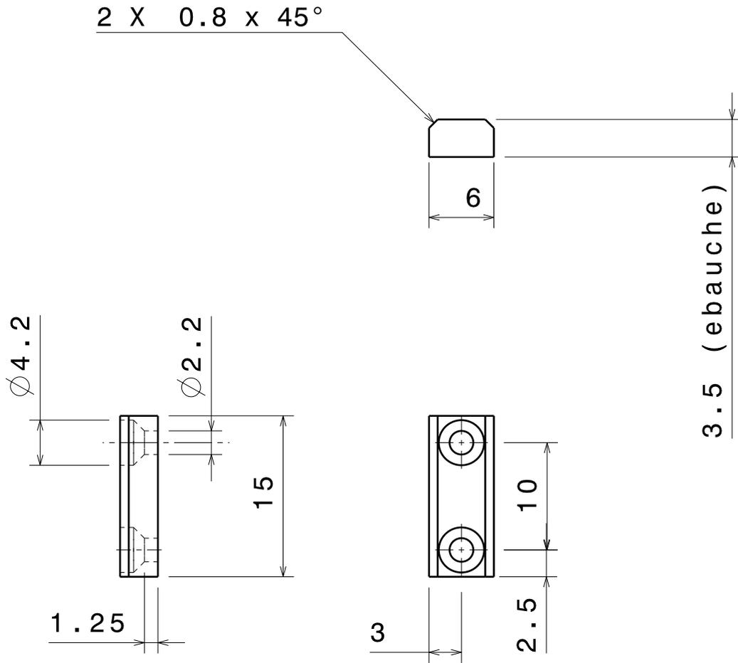
La mise à l'épaisseur finale à 20°C sera réalisée Cale en place sur le Moteur en respectant un jeu entre Cale et Structure de base de 0.2 +0 / - 0.05
